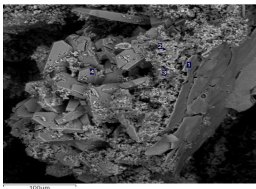
Рис. 9 – Новообразования на поверхности известняка при pH-5,8
