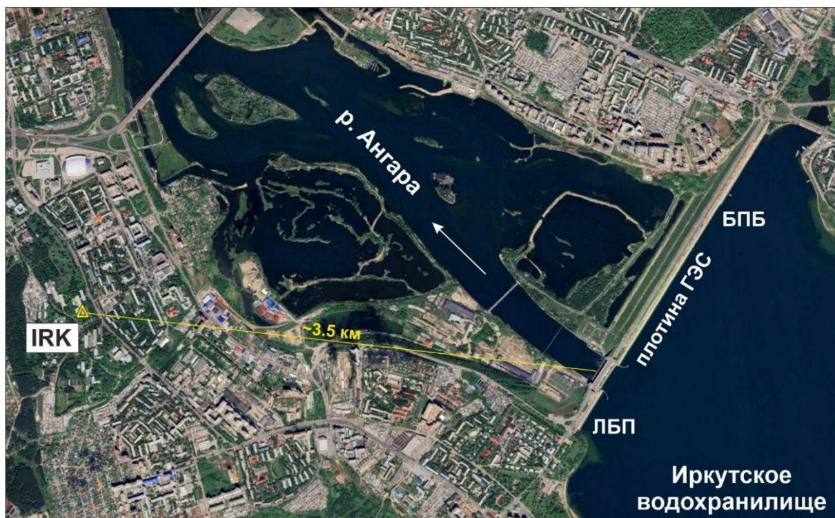
Рисунок 4.6 – Положение плотины ГЭС и сейсмической станции IRK. Желтым треугольником показана станция IRK, желтой прямой – трасса «плотина – станция», цифрами – расстояние, ЛБП – левобережная плотина, БПБ – правобережная плотина, стрелкой показано направление течения р. Ангара. В качестве подложки использован космический снимок Google Earth.
