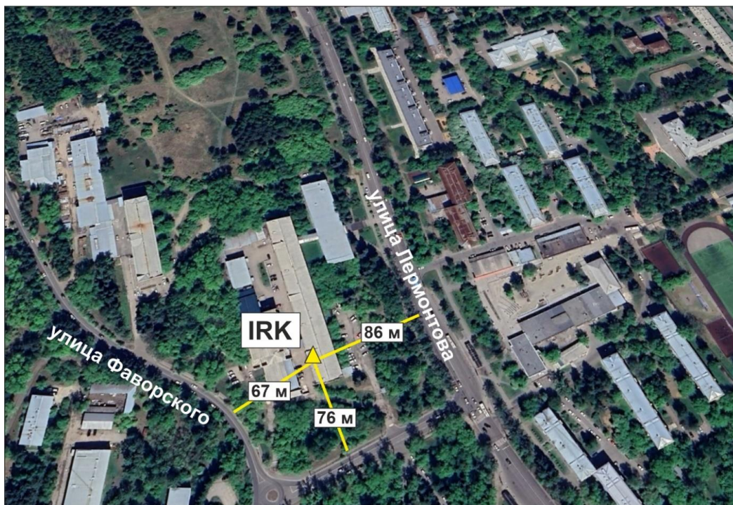
Рисунок 4.12 – Положение сейсмической станции IRK и автомобильных дорог. Треугольником показана сейсмическая станция, желтые прямые показывают кратчайшие расстояния до автодорог, цифрами показано минимальное расстояние. В качестве подложки использован космический снимок Google Earth.
